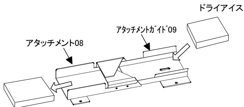
★ アタッチメントは包装するドライアイスの大きさに合わせて製作しますので包装するドライアイスの寸法をお知らせください。
